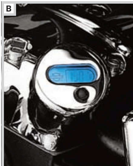
B. ÖLTEMPERATUR-PEILSTAB MIT BELEUCHTETER LCD-ANZEIGE
