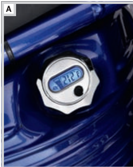
A. PEILSTAB FÜR ÖLSTAND UND ÖLTEMPERATUR MIT BELEUCHTETER LCD-ANZEIGE – CHROM (ROCKER ABGEBILDET)
